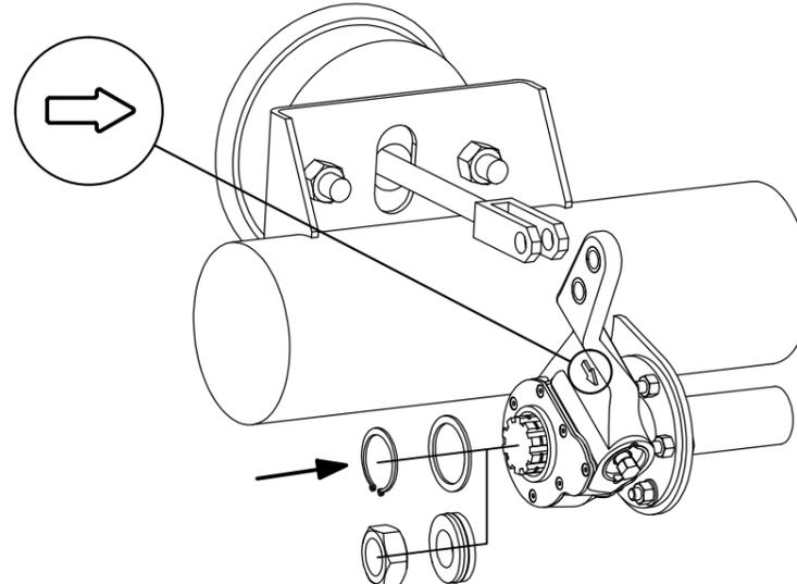
Установите регулятор на шлицы кулака. Направление действия тормозной силы должно совпадать с направлением стрелки на корпусе регулятора.
