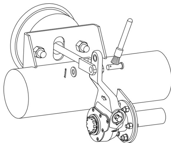
Нанесите смазку на рабочую поверхность пальца тормозной камеры. Соедините корпус регулятора с вилкой тормозной камеры при помощи пальца, шайбы и шплинта.
