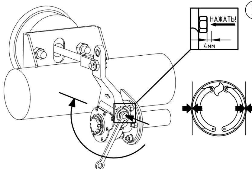
Утопите фиксатор внутрь регулятора до упора, нажав на его торец пальцем и вращайте его ключом по ходу часовой стрелки до упора, т.е. до соприкосновения тормозных колодок с барабаном.
