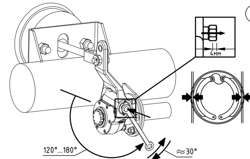
Отверните фиксатор против хода часовой стрелки на  $120^\circ \dots 180^\circ$ . При этом между тормозными колодками и барабаном установится зазор, близкий к требуемому.
