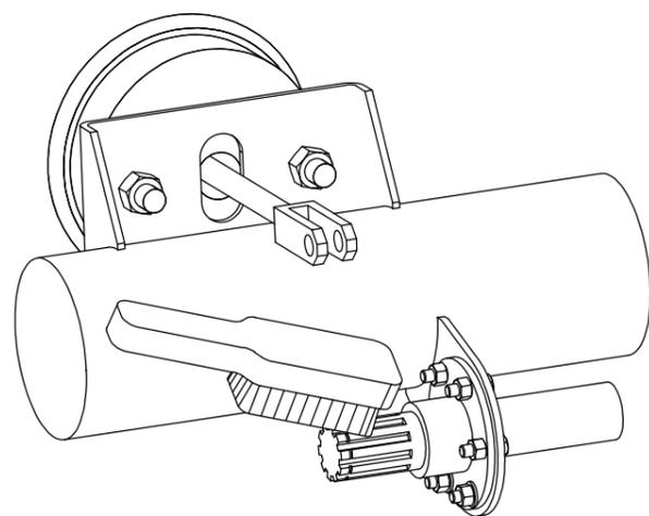
Очистите шлицы разжимного кулака и нанесите на них смазку.
