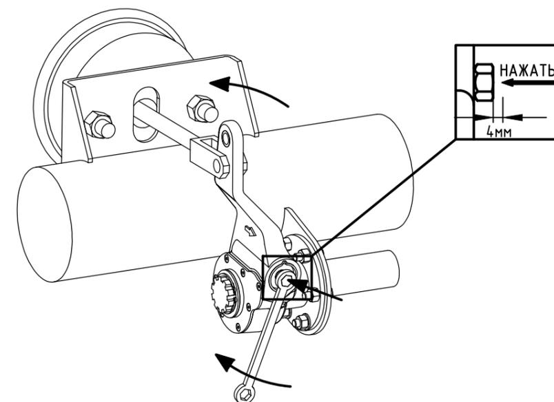
Утопите фиксатор внутрь регулятора до упора, нажав на его торец пальцем, и вращайте его ключом по ходу часовой стрелки до совмещения отверстий корпуса регулятора и вилки тормозной камеры
